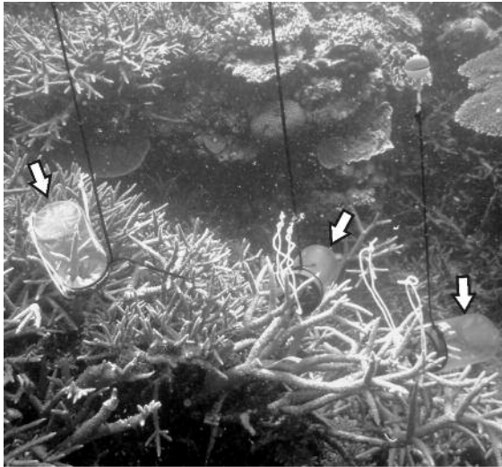
図4 スギノキミドリイシに装着した透明容器製の褐虫藻トラップ(白矢印) 口部分は巾着袋になっており、サンゴ枝を容器内にいれ巾着袋のひもを絞ることで容易に装着が可能。容量は1L。容器内および巾着袋でサンゴ枝を擦らないよう装着時には細心の注意が必要。
